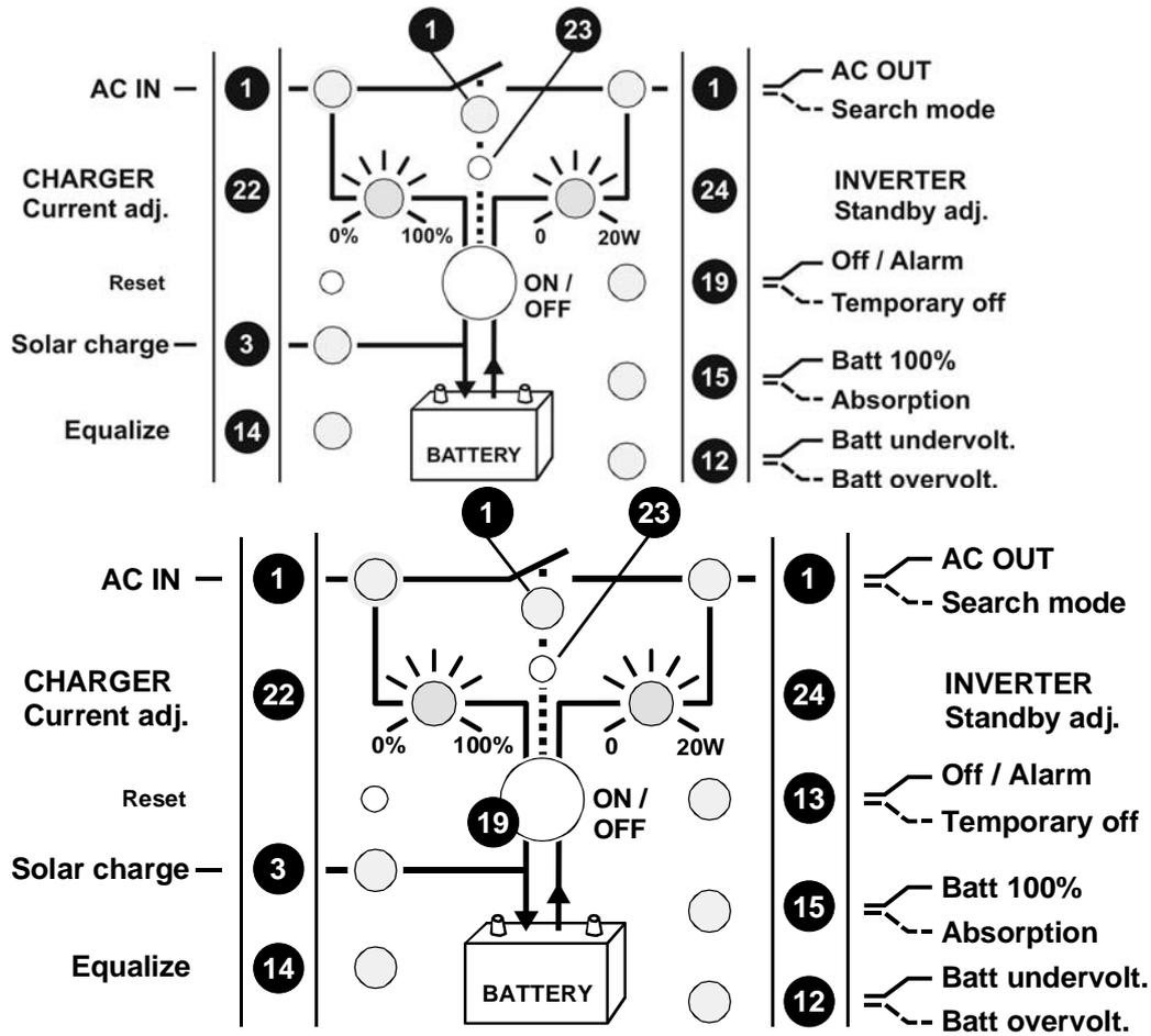
4.2 Anzeigen und Bedienelemente für der Fernsteuerung (Remote control)
